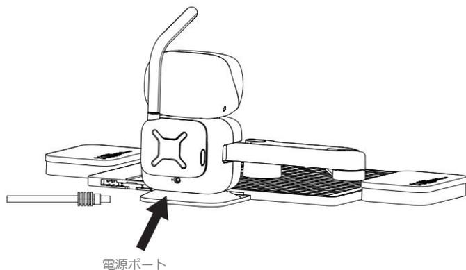
4. 電源ケーブルをロボットの電源ポートに挿入してください。
