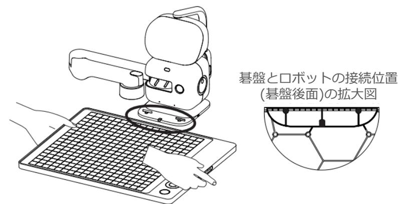
2. 碁盤をロボットの足部の取付穴に合わせて上からかぶせるように垂直に入れてください。
