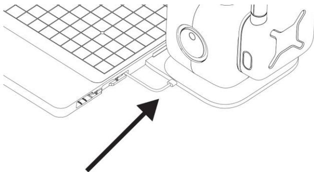
3. 碁盤に埋め込んであるケーブルをロボットのベースにあるUSBポートにカチッとまで挿入してください。
